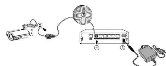
1. Подключить кабель «витая пара» RJ-45 в разъем \*POE коммутатора. (если коммутатор не поддерживает POE подключаем в один из разъемов LAN коммутатора (или в порт Ethernet компьютера если подключение осуществляется прямо к компьютеру). \* Если коммутатор не поддерживает POE, а также в том случае если камера подключается напрямую к компьютеру, подключаем к камере отдельный блок питания 12V DC (в комплекте с камерой не входит).
