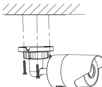
Затем настраиваем по месту обзор камеры используя вращающиеся горизонтальную и вертикальную подставку в различных осях.
