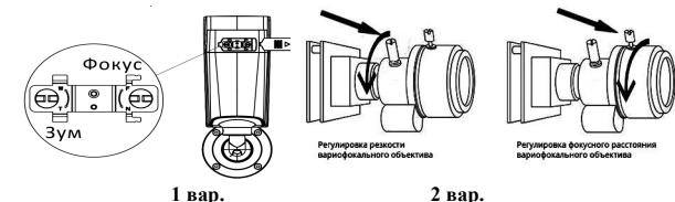
\*При первом варианте регулировочные винты находятся на корпусе камеры. При втором варианте придется снять кожух объектива, либо просто открутив его рукой, либо используя специальную широкую лопатку отвертку вставляемую в прорези на боковых кромках кожуха объектива. Далее находим два регулировочных винта на основании объектива и настраиваем камеру. При наличии моторизованного вариофокус управляет из административной панели.
